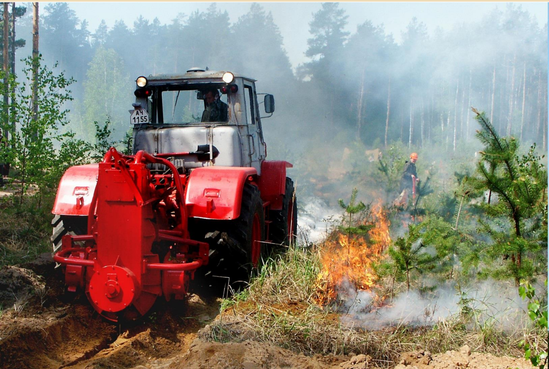
Т-150К с грунтометом ГТ-3 способен создавать полосы до 2 км/час
