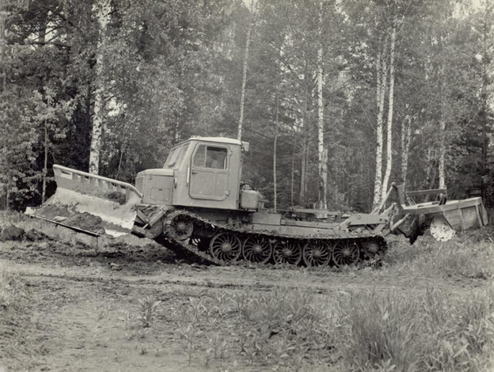
Трактор ТТ-4, оборудованный клином и плугом ПЛК-2
